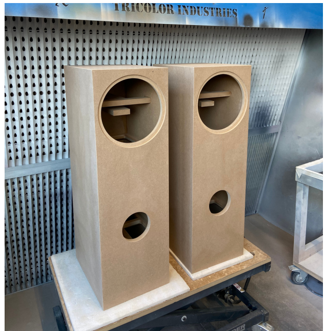
L'arbre en boule (69) Fabrication d'enceintes, usinage sur CN, assemblage à 45°
