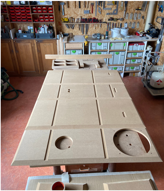
L'arbre en boule (69) Fabrication d'enceintes, usinage sur CN, assemblage à 45°
